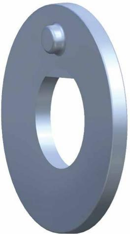
Specijalna FKL osiguravajuća podloška sprečava okretanje osovine prilikom pritezanja navrtke i zbog opružnih osobina obezbeđuje aksijalnu silu stezanja od 6 tona.
