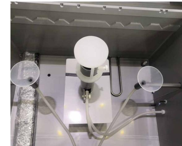
4. Testiranje u slanoj komori
